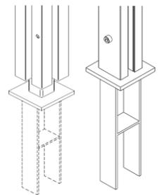
Sie müssen die Schrauben so fest anziehen, dass der innere Aluminium-Pfostenkern sich an den Stahlanker anschmiegt.
